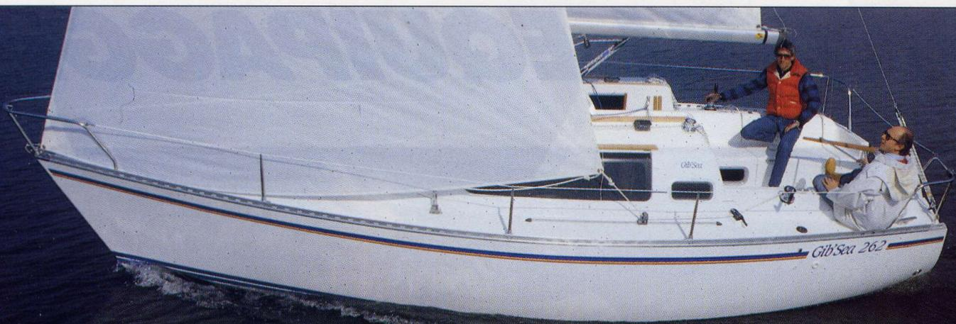
*Molto funzionale e semplice, il 262 è in grado di offrire ottime prestazioni in tutte le andature. Il pozzetto, molto ampio ospita comodamente più di cinque persone. Due le chiglie fornite da cantiere, quella fissa e quella mobile che riduce il pescaggio dell'imbarcazione a soli 60 cm. Bello lo slancio di prua, un pò alto il bordo libero e la tuga.*
